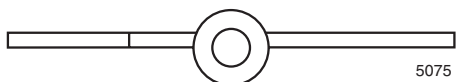
Gångjärn 5075 Storlek 2 3/4" x 1" Material: Obehandlat stål Förebild: Aug Stenman N:o 224 Varianter: Höger och vänster (H visas)
